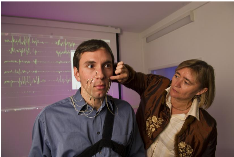
Elektroden zeichnen die Muskelbewegungen auf, über Mustererkennungsverfahren schließt Tanja Schultz (rechts) von den Signalen zurück auf lautlos Gesprochenes (Foto: Nils Gräber)
