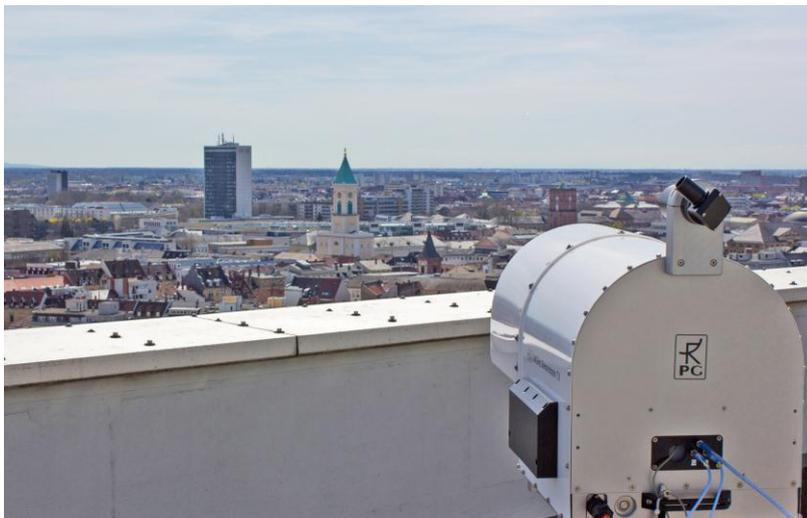
*Mit einem Langstreckendemonstrator zwischen zwei Hochhäusern in Karlsruhe konnte bereits eine Distanz von über einem Kilometer überbrückt werden. Bild: Ulrich Lewark / KIT*
