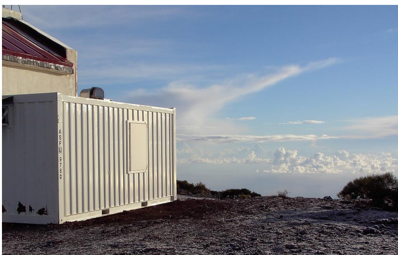
Mit Infrarot-Spektrometern lässt sich die Luftzusammensetzung in der Atmosphäre bestimmen. Auf Teneriffa betreiben das KIT und der spanische Wetterdienst gemeinsam einen Messcontainer (Foto: Thomas Blumenstock, KIT).
