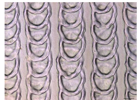
Schuppenstrukturen vertikal und horizontal überlappend (oben) bzw. in Reihen mit Abstand (unten) (Interferometer-Aufnahmen: Christian Greiner, KIT)
