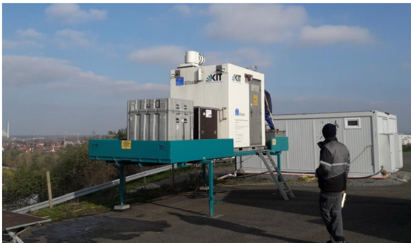
Das Doppler-LIDAR des KIT auf dem Energieberg misst die Windgeschwindigkeit in hoher räumlicher und zeitlicher Auflösung (Foto: Bianca Adler)
