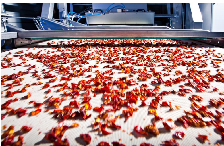
Ob Dörrobst, Schotter oder Müll, das alles wird auf Bandsortieranlagen nach Größe oder Qualität geordnet. (Bild: Fraunhofer IOSB)
