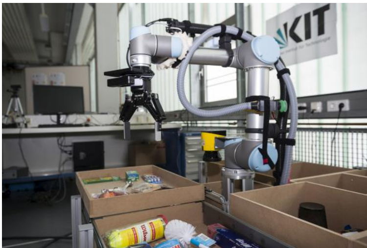
Der Roboter des Team IFL PiRo erkennt die gesuchten Objekte und stellt sie selbstständig im Warenkorb zusammen. (Bild: Laila Tkotz, KIT)
