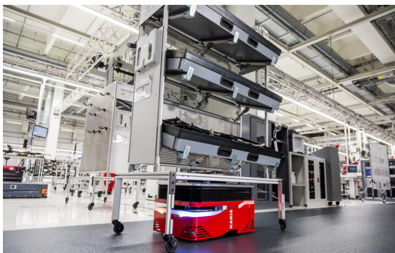
Der kleine Logistik-Roboter Karis Pro kann erstaunlich große Lasten transportieren. (Bild: KIT, Audi Sport GmbH)
