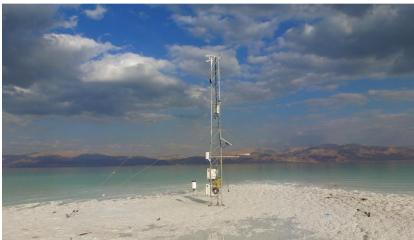
Die mit 429 Metern unter dem Meeresspiegel tiefstgelegene meteorologische Station auf der Erde misst kontinuierlich die Verdunstung des Wassers des Toten Meeres (Foto: U. Corsmeier, KIT)
