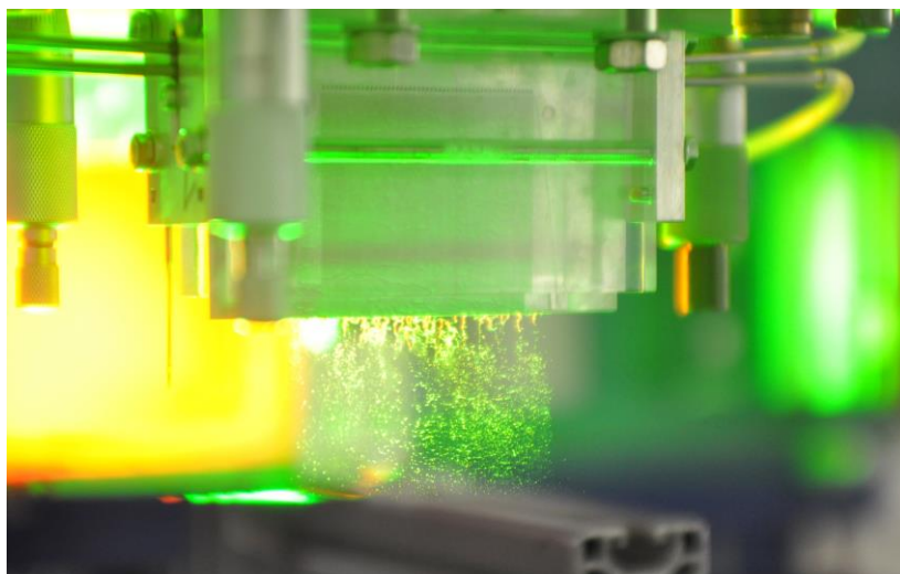
Zerstäubung des Kerosins im Experiment: Ziel der Simulationen ist es, die optimale Tropfenverteilung zu berechnen (Foto: KIT)
