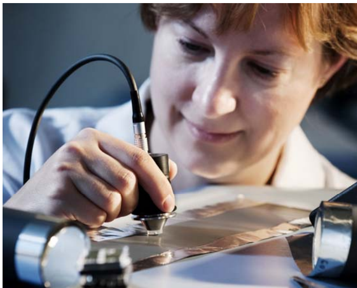
Viele Schritte auf dem Weg vom Material zur Batterie: Das Bild zeigt die Messung der Dicke einer neu beschichteten Elektrode. (Foto: Sandra Göttisheim)
