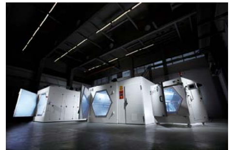
Im KIT wurde ein großes Versuchszentrum für den industriellen Einsatz der Mikrowellentechnologie für Verbundwerkstoffe aufgebaut. (Foto: KIT)
