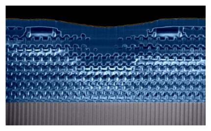
Im Elektronenmikroskop ist die eigentliche optische Tamkappe unter der Wölbung im Goldfilm (gelbrot) erkennbar. (Colorierte REM-Aufnahme; Quelle: CFN)
