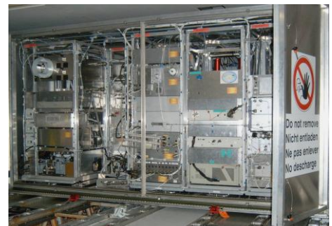
Mit dem Forschungslabor CARIBIC können rund 100 Spurengase und Eigenschaften von Aerosolpartikeln vermessen werden. (Foto: MPI für Chemie, Mainz)
