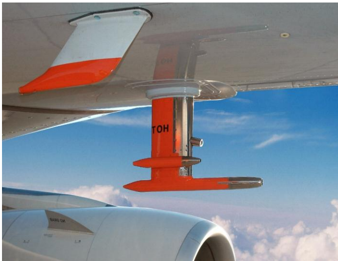
Durch das Einlass-System wird die Luft dem Forschungslabor CARIBIC zugeführt. (Foto: Lufthansa)
