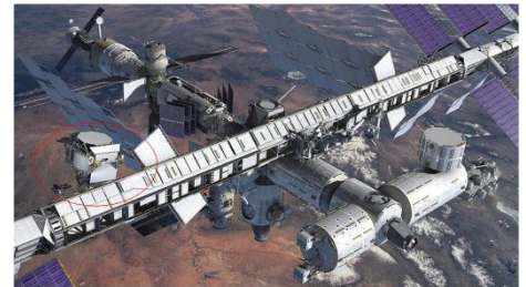
Die internationale Raumstation ISS im Modell. Der geplante Standort des AMS-02-Detektors links unten im Bild ist markiert. (Bild: NASA/AMS)
