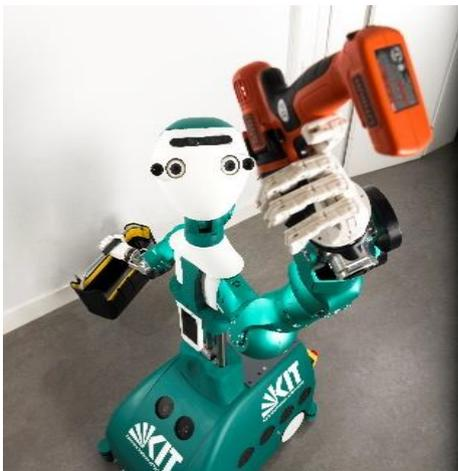
*Lernwilliger Helfer: Der Assistenz-Roboter ARMAR 6 kann allein durch Beobachtung neue Fähigkeiten erwerben, Nutzer unterstützen und etwa Werkzeug reichen. (Bild:KIT/Laila Tkotz)*
