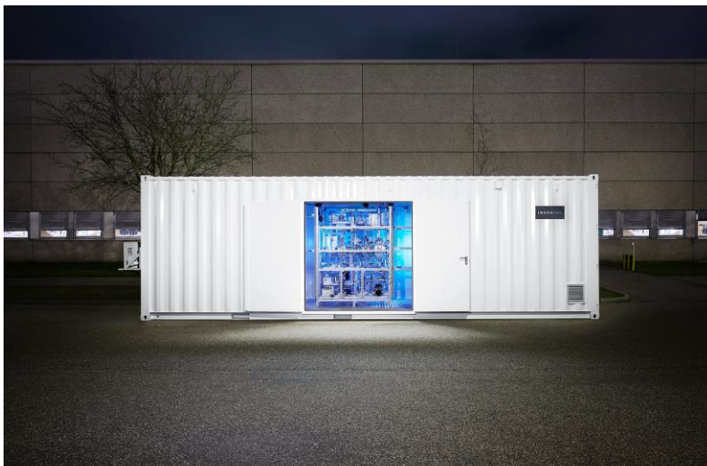
Ineratec baut chemische Reaktoren, die so kompakt sind, dass die gesamte Anlage fertig montiert in einen Schiffscontainer passt. (Foto: INERATEC/Hauser)
