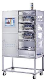
Das Karlsruher Expositionssystem ist kompakt und kann auch Feinstaubbelastungen am Ort der Belastung messen. (Bild: VITROCELL Systems GmbH)
