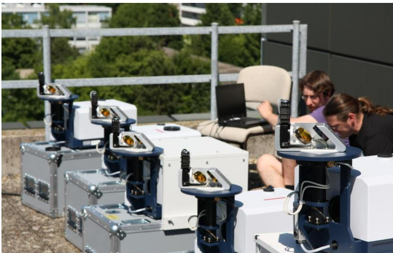
Vergleichsmessungen mit mehreren Fourierspektrometern auf der Dachterrasse des KIT-Instituts für Meteorologie und Klimaforschung. (Foto: Dr. Frank Hase)
