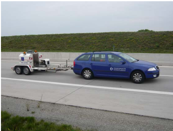
Prüfung der Tragfähigkeit einer Straße: Das Falling Weight Deflectometer (FWD) kann eine Belastung von fünf Tonnen aufwärts simulieren. (Foto: ISE)
