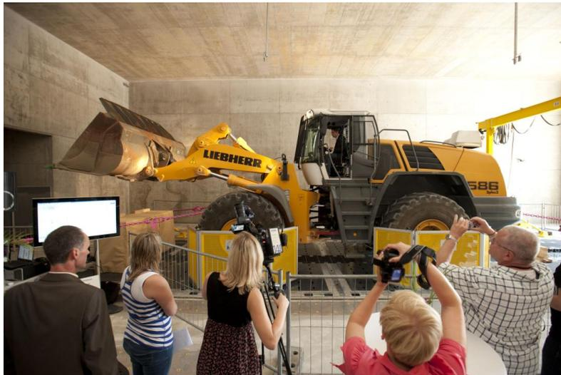
In Aktion: ein 40-Tonnen-Radlader auf dem Akustikrollenprüfstand (Foto: Martin Lober)
