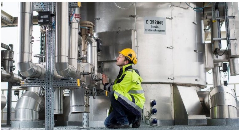
In der Bioliq-Anlage am KIT wird erforscht, wie man aus trockener Biomasse, etwa Reststoffe aus Agrar- und Forstwirtschaft, hochwertige Biokraftstoffe herstellen kann. (Foto: Fabry)
